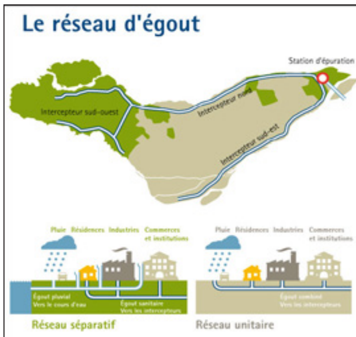
Figure 12 : Le réseau d'égout de Montréal.
