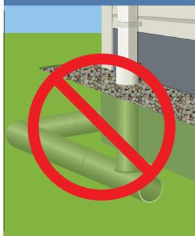
Raccorder une gouttière au drain de fondation, trop près de votre bâtiment, l'orienter vers une surface imperméable ou vers le drain de votre garage en contre-pente n'est plus permis.
